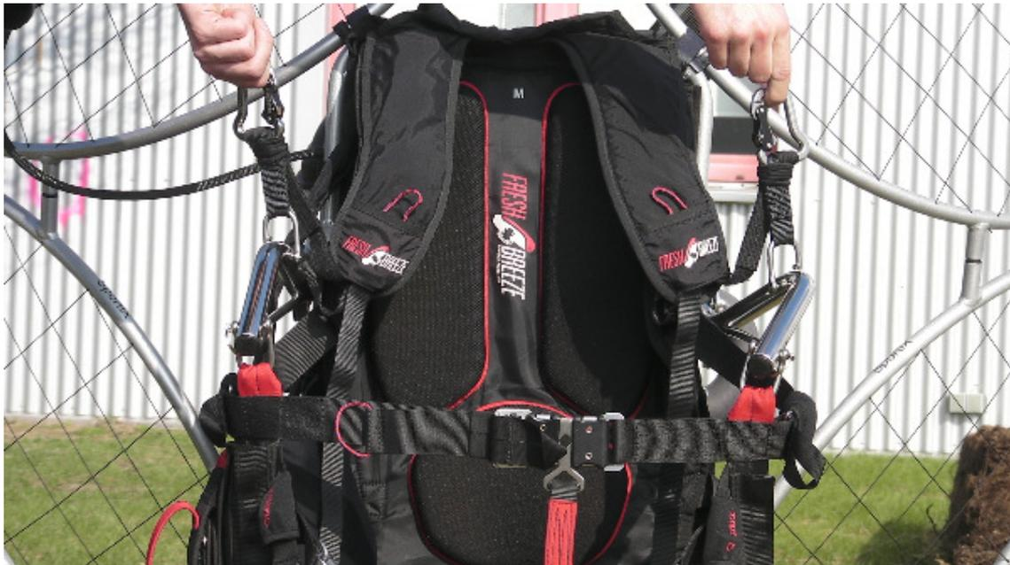
Leichte Piloten können eine spezielle linke Schubstrebe verwenden. Diese gleicht das Drehmoment des Motors besser aus. Diese Schubstrebe ist nach außen verdreht und kompensiert den ständigen Linksdrall der Flugrichtung während der Motor unter Last läuft.
