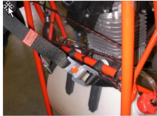
Die integrierte Rettung bietet größtmöglichen Komfort, aber die V-Leine muss wie auf dem Bild gezeigt, außen an der Schubstrebe im Tunnel verlegt werden. Beginnend von der Rettung verläuft die V-Leine aufwärts Richtung Schulter.
