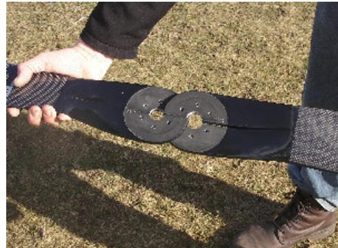
Der Propeller wird mittels der 6 Schrauben und der Propellerplatte am Getriebeflansch angeschraubt. (M6 x 35; 10mm Nm)
