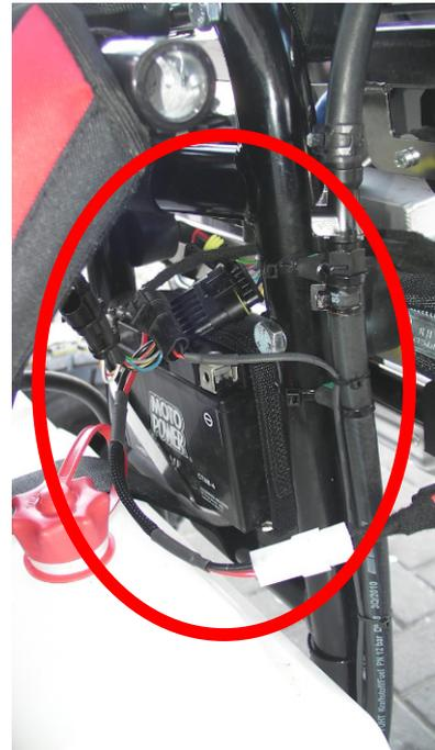
Hier befindet sich die Hauptsicherung mit 15 A des Stromkreises der Batterie.
