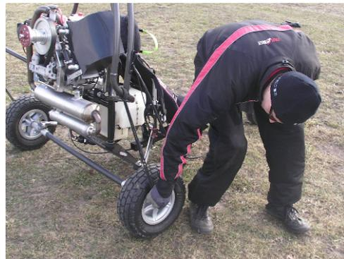
... wird mit dem am Ende befindlichen Haken an der Radaußenseite eingehängt.
