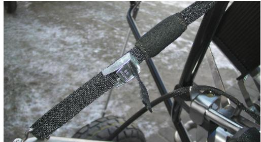
Der Schirm wird in den Karabinern eingehängt. Die Bremsleinen sollten hier durch die untere Rolle laufen, damit die Bremseschleife im Flug jederzeit erreicht werden kann.
