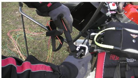
Die Aufziehhilfe wird in die A-Leine gehängt.
