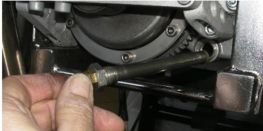
Bei jedem zweiten Ölwechsel muss dieses Sieb gereinigt werden. Gib beim montieren des Ölsiebs acht, dass der Stutzen im Ölraum getroffen wird. Diese Schraube wird mit 26 Nm angezogen. Das Ölvolumen beträgt 900 ml. Das zu verwendende Öl ist Castrol Edge Vollsynthetisch 0W-40.
