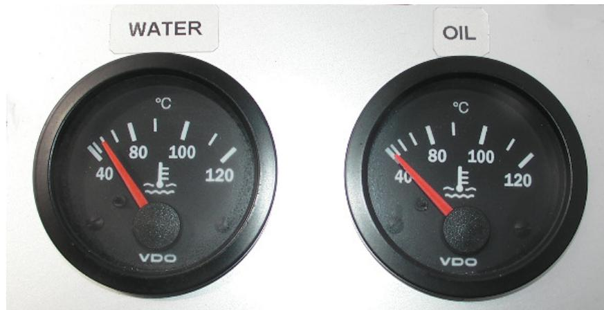
Wasser -und Öltemperaturanzeige liegt im Reiseflug zwischen 70-80 °C
