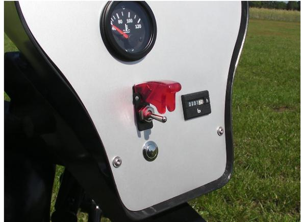
Der E-Start wird durch das Betätigen des Drucktaster aktiviert. Der Motor wird im Leerlaufstellung des Gashebels gestartet.
