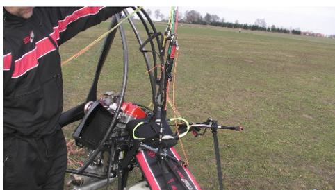
Die richtige Länge der Aufziehhilfe ist unbedingt zu prüfen. Die rote Leine der Aufziehhilfe muss leicht durchhängen, wenn der Tragegurt nach oben, 90 ° zur Schubstrebe, gezogen wird. Diese Einstellung sollte durch einen erfahrenen Fluglehrer erklärt/ eingestellt werden.
