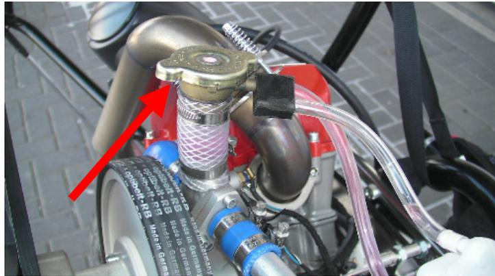
Ausgleichsbehälter für Kühlwasser sollte stets teilweise gefüllt sein.
