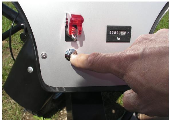
Wenn die rote Abdeckung geschlossen wird, schaltet der Motor ab.
