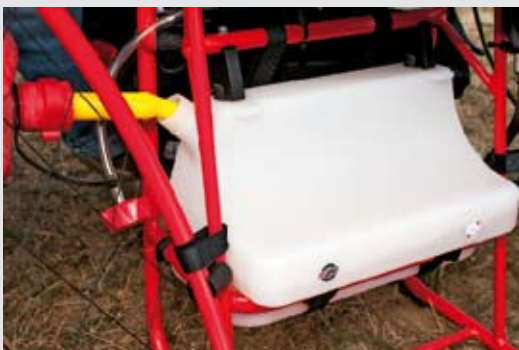
Vorbildlich: Der Einfüllstutzen des Tanks ist sehr gut zugänglich und erlaubt kleckerfreies Betanken, ohne zuvor den Sitzgurt verschieben zu müssen.
