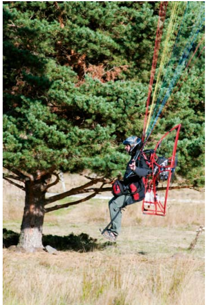
Haltungsschule: Sobald sich der Pilot aufrichtet, kippt der Aufhängungslenker nach unten und sein Drehpunkt verschiebt sich nach vorne - der Motor drückt den Piloten so ganz automatisch noch weiter nach vorne in Laufhaltung.
