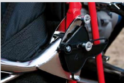
Auf den ersten Blick befremdlich: Der Schnappmatik-Mechanismus ist mit Pushpins befestigt, zeigt bewusst- deutliches laterales Spiel und ist mit einer Plastikabdeckung zum Schutz der Pilotenfinger versehen...
