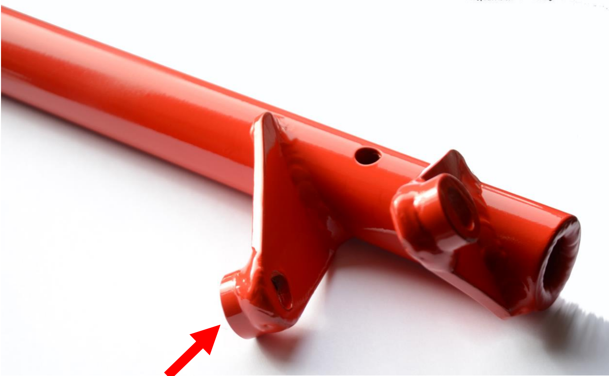
Bild 3: Dünne Laschen mit aufgeschweißter Buchse. Muss nicht getauscht werden
