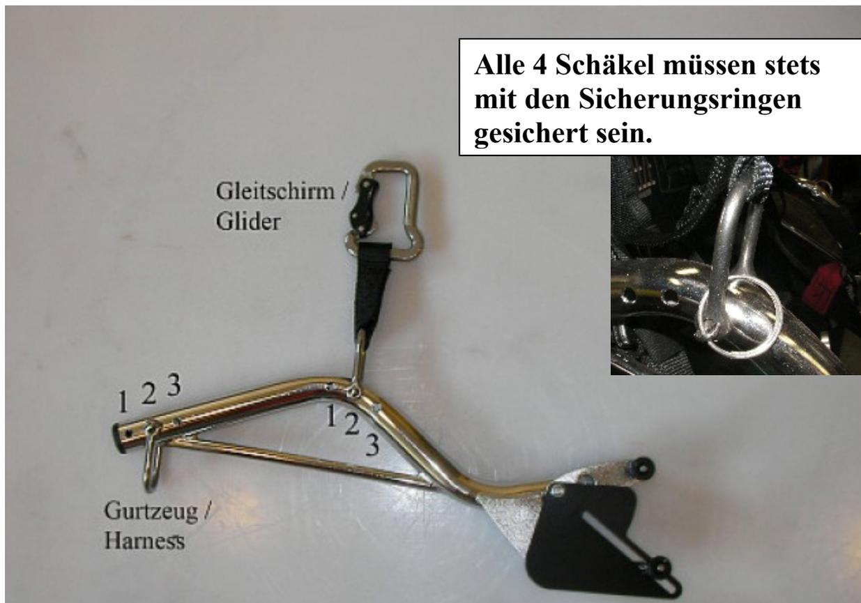
Das Gleitsegel und Gurtzeug kann in verschiedenen Positionen der flexiblen Schubstange eingehangt werden. Dies ist notig, um verschiedenen Pilotengewichten die optimale Sitzposition zu garantieren. Ab Werk sind jeweils die Positionen 2 in Verwendung.
