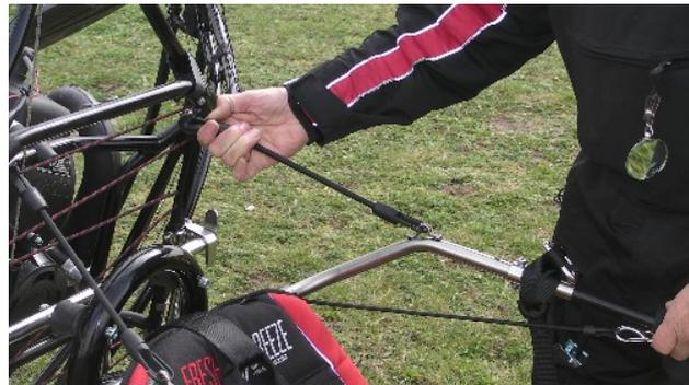
Die Schirmaufhängung kann wahlweise in 3 verschiedenen Positionen erfolgen. Je nach Pilotengewicht muss sie eingestellt werden. Bei schweren Piloten ( 100 kg) kommt sie wie im Bild zu sehen, in die vordere Position. Je leichter der Pilot ist, desto weiter hinten ist die Schirmaufhängung zu wählen.
