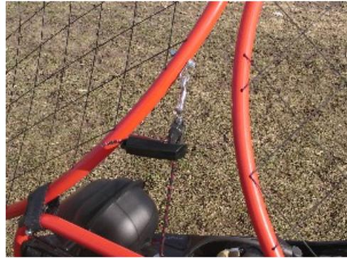
Der Propeller ist zweiteilig. Vor der Montage muss er zusammengesteckt werden. Achtung! Die Propellerhälften nicht verdreht zusammenstecken. Im Trikebetrieb empfehlen wir den 4-Blatt Propeller zu montieren. Dieser hat gegenüber der 2-Blatt-Version 6 kg mehr Standschub. Bessere Steigwerte sind damit zu erzielen. Diese sind wie im Bild zu erkennen, gekreuzt anzubauen.
