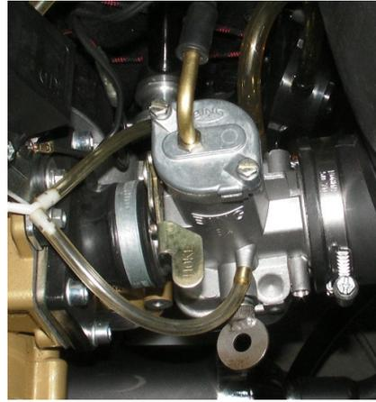
Der Schieber kann dann einfach als Ganzes aus dem Vergaser gezogen werden. Die Nadel ist an unterster Stelle im Schieber platziert.
