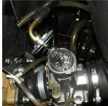
Die Nadel hat die Bezeichnung 6L1 und wird in 2ter Stellung von oben eingehängt. Beim Wiedereinbau ist unbedingt auf die Reihenfolge zu achten.
