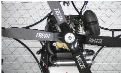
Der Propeller wird mittels der 6 Schrauben und der Propellerplatte am Getriebeflansch angeschraubt. (M8 x 35; 14Nm bei 4 Blatt und M 8 x 35; 10 Nm bei 2 Blatt)
