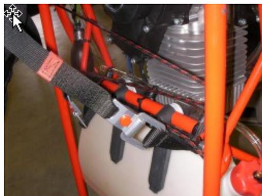
Die integrierte Rettung bietet Sicherheit und dennoch größtmögliche Bewegungsfreiheit. Die V-Leine muss wie auf dem Bild gezeigt, außen an der Schubstrebe im Tunnel verlegt werden. Beginnend von der Rettung verläuft die V-Leine aufwärts Richtung Schulter.
