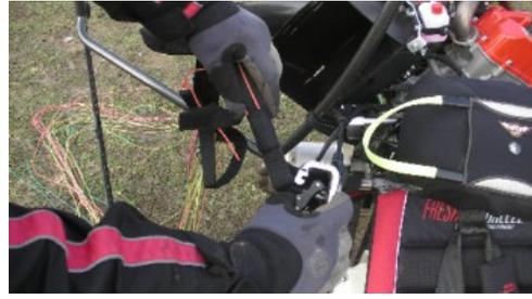
Die Aufziehhilfe wird in die A-Leine gehängt.
