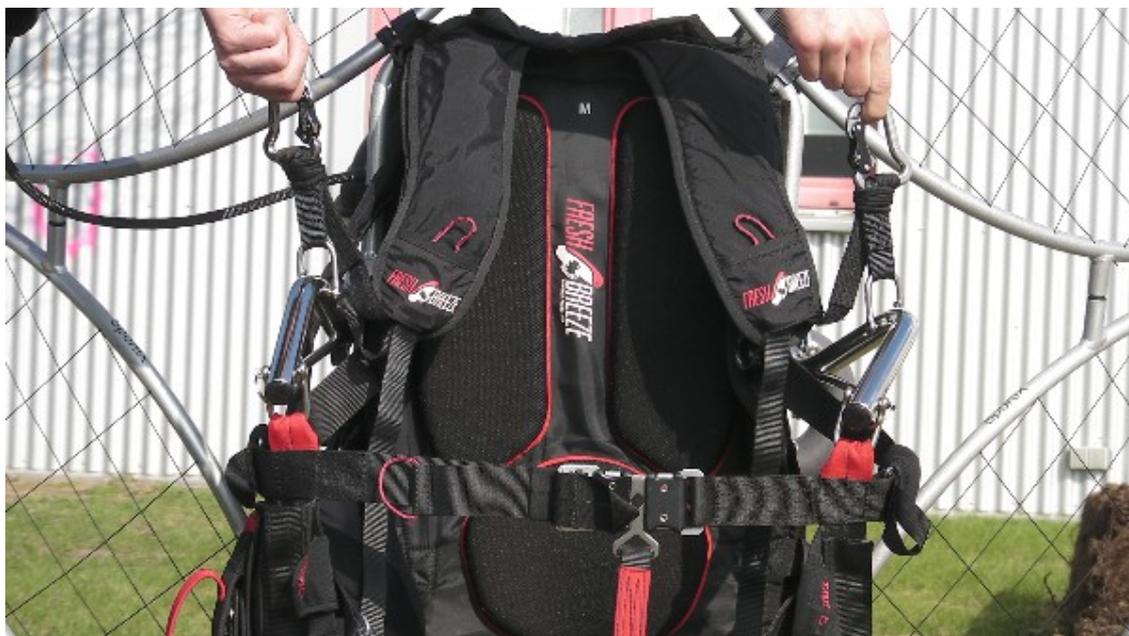
Der Super ThoriX hat Nicht- Gleiche Schubstreben. Die linke Schubstrebe ist nach außen gedreht. Diese gleicht das Drehmoment des Motors besser aus. Sie kompensiert den ständigen Linksdraht der Flugrichtung während der Motor unter Last läuft. Da der ThoriX 190 eine entgegengesetzte Propellerdrehrichtung hat, ist die rechte Schubstrebe hier nach außen gedreht.
