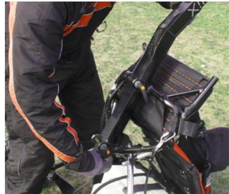
Die Hinterräder sind für den Transport leicht abnehmbar. Der eingesteckte Achszapfen wird mittels Klappbolzen gesichert. Luftdruck 1,5 bar
