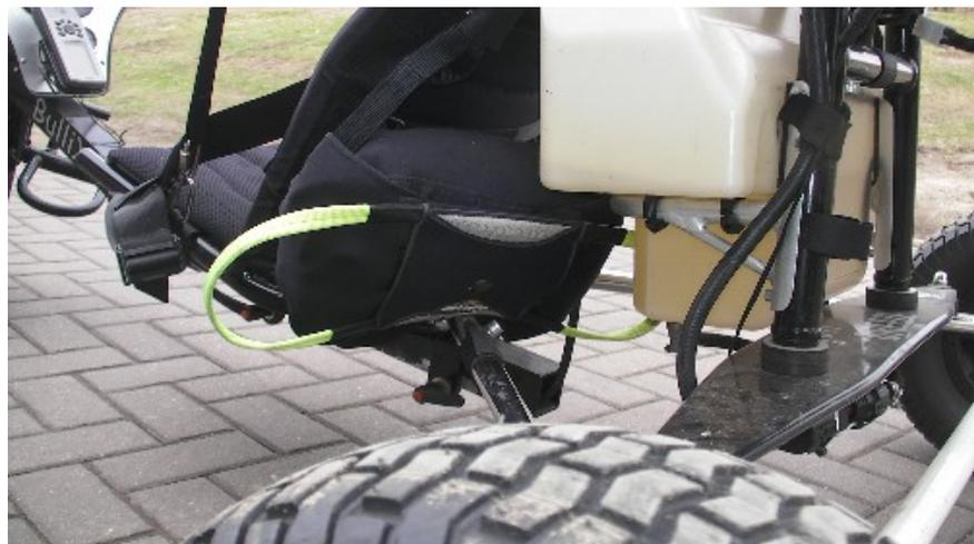
Das Rettungsgerät kann Überkopf oder hinter dem Sitz angebracht werden.
