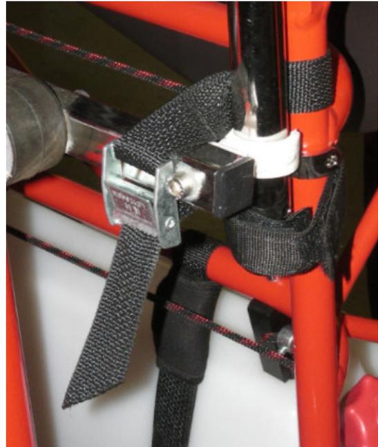
Die Schubstange werden mittels dieser Gummiseile in waagerechter Position gehalten.
