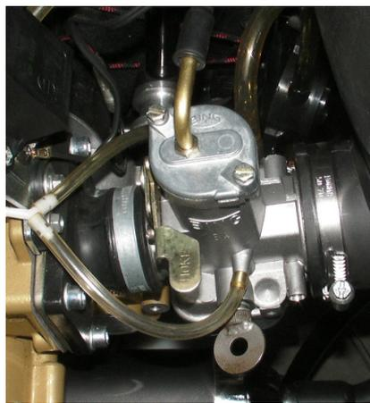
Der Schieber kann dann einfach als Ganzes aus dem Vergaser gezogen werden. Die Nadel ist an unterster Stelle im Schieber platziert.
