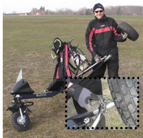
Am Rahmen müssen jetzt die beiden Multifunktionsrohre angebaut werden. Diese werden oben mit den Quickpins befestigt und unten mit dem Klettband.
