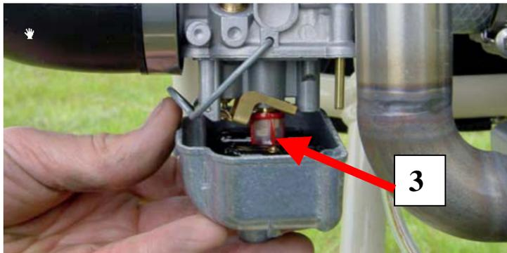
Die Hauptdüse (2) wird mit einem 8 mm Schraubenschlüssel herausgedreht. Nummer 3 ist die Leerlaufgemischdüse mit der Bezeichnung 60. **Auf keinen Fall darf hier eine kleinere als 50 eingebaut werden.**
