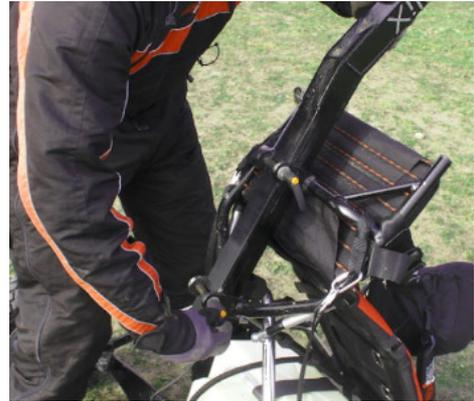
Die Hinterräder sind für den Transport leicht abnehmbar. Der eingesteckte Achszapfen wird mittels Klappbolzen gesichert. Luftdruck 0,4 bar
