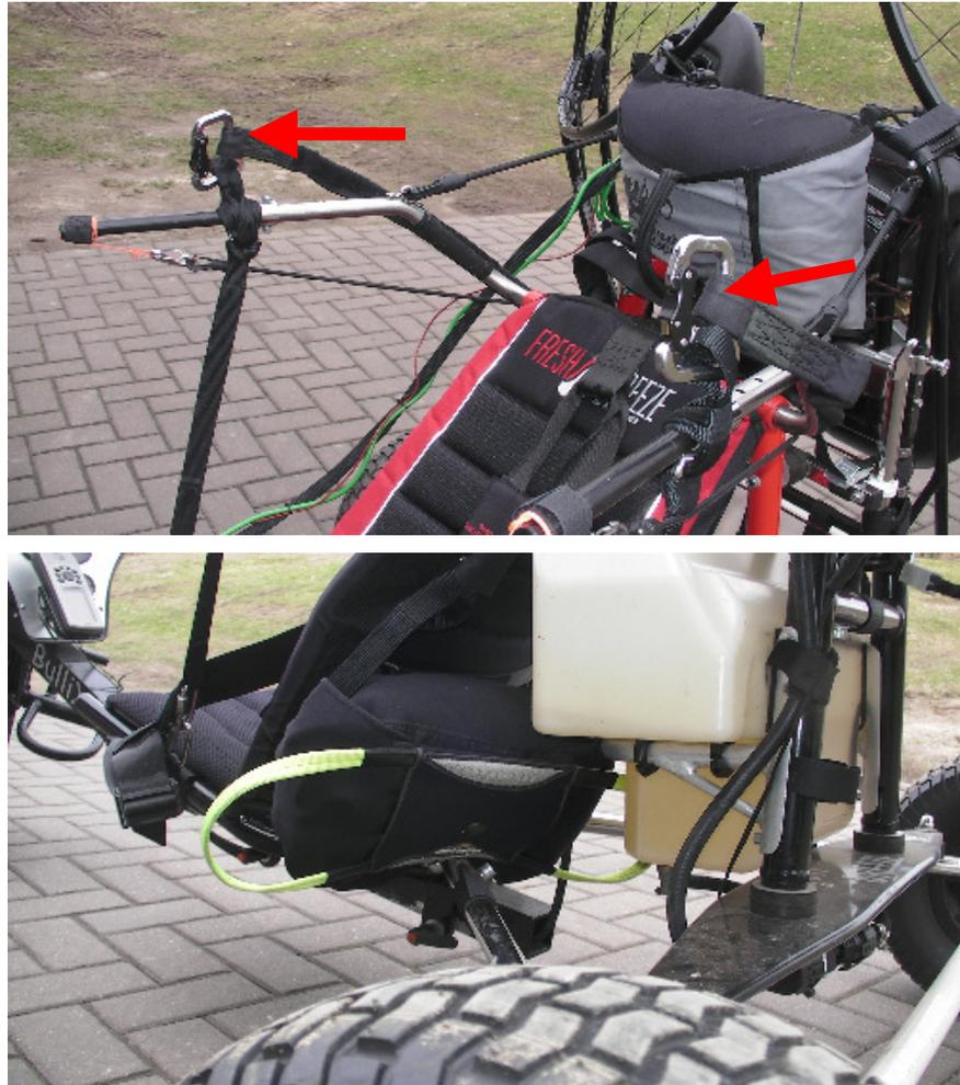
Das Rettungsgerät kann Überkopf oder hinter dem Sitz angebracht werden. Die V-Leine des Rettungsgerätes muss dabei zu den Karabinern der Schirmaufhängung geführt und in diese eingehängt werden. Der Vorteil der Überkopfbefestigung liegt darin, dass die Auslösung mit der rechten sowie linken Hand ausgeführt werden kann. Das Rettungsgerät muss so groß ausgewählt sein, dass das MTOW berücksichtigt ist.
