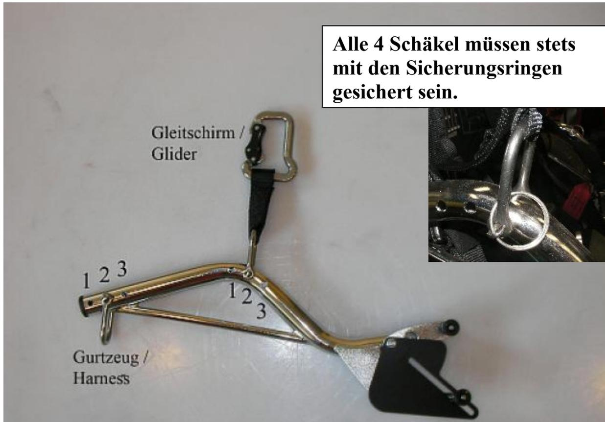
Das Gleitsegel und Gurtzeug kann in verschiedenen Positionen der flexiblen Schubstange eingehängt werden. Dies ist nötig, um verschiedenen Pilotengewichten die optimale Sitzposition zu garantieren. Ab Werk sind jeweils die Positionen 2 in Verwendung.
