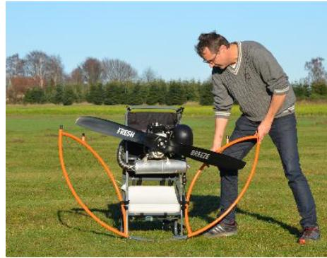
Danach werden die beiden oberen Käfigteile in den Rahmen/Käfig gesteckt.
