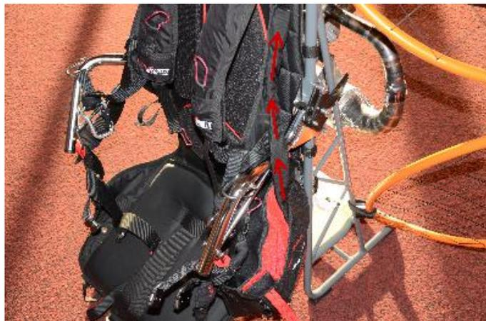
Dort teilt sie sich zur rechten und linken Schulter. Die V-Leine verläuft integriert über den Schulter unter einer Stoffabdeckung des Gurtzeuges und endet in den Hauptkarabinern.
