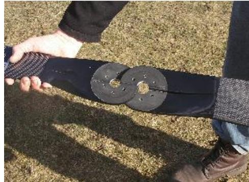
Der Propeller wird mittels der 6 Schrauben und der Propellerplatte am Getriebeflansch angeschraubt. (M6 x 50mm; 10 Nm)
