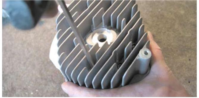
Das Dekompressionsloch ist überhalb des Auslasskanals zu erkennen. In der birnenförmigen Vertiefung lagert sich nach einiger Zeit oder bei Gebrauch minderwertigem Öl, das sogenannte Carbon ab. Das Deko-Loch ist verschlossen. Die Ablagerungen entfernt man am leichtesten, indem mit einem 3,5 mm Bohrer vorsichtig die Bohrkanäle durchbohrt werden.
