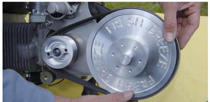
Sollte der Riemen trotz ausreichender Spannung erhebliche Quietsch-Geräusche machen, so gibt man 2 Hübe Riemen-spray auf die untere Riemenscheibe. Rutscht der Riemen trotz ausreichender Spannung, sollte dieser ausgetauscht werden.
