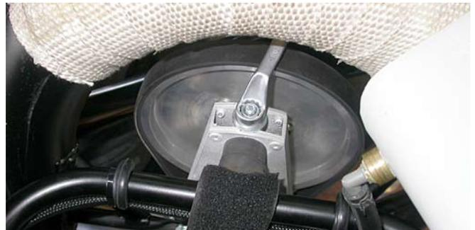
3. Anschließend unbedingt wieder die Zentralmutter M16x1,5 festziehen (36 Nm)!
