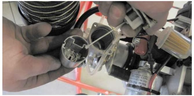
Der Vergaser ist ausgerüstet mit der Nadel 6L1 und eingehängt in der 2. Position von oben.
