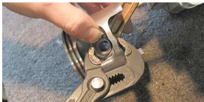
Der Kolben besitzt zwei unterschiedliche Kolbenringe. Der oberste hat eine Markierung „O“. Diese muss nach oben zeigen.
