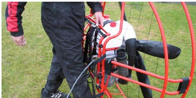
Eine Fixierung wird mit den Klettbindern verhindern unbeabsichtigtes lösen des Motors von Rahmen.
