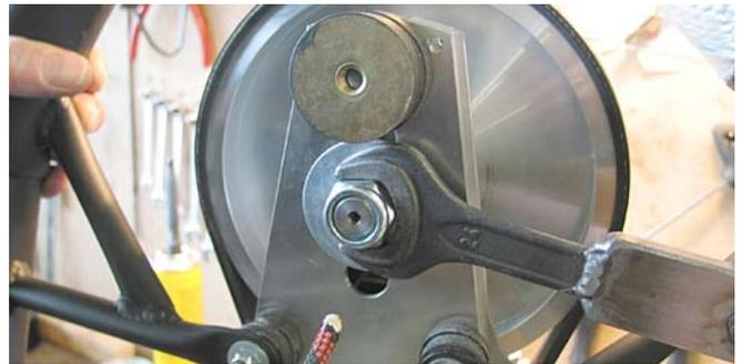
2. Stopmutter M8 auf dem Gewindestift nach unten schrauben und dadurch die Nabe nach oben ziehen, der Riemen strafft sich dabei. Dabei darauf achten, dass der Gewindestift M8x80 vollständig eingeschraubt bleibt (Imbus SW 5mm) und somit die Welle gegen Verdrehen gesichert ist. Dieser Stift muss mit mittelfestem Loctite (blau) gesichert sein.
