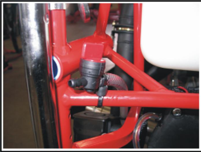
Hinter dem rechten Multirohr haben wir den Einfüllstutzen mit Überdruckdeckel der ab ca. 95-100 °C bzw 0,9 bar Überdruck aufmacht!
