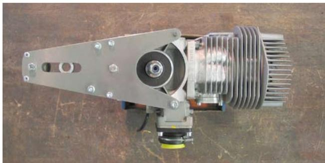
Der Motor hat eine starke Hitzeentwicklung. Besonders beansprucht ist dabei der Kolben und der Zylinder auslassseitig. Wird der Resonator am Auslass demontiert, ist der Kolben mit seinen beiden Kolbenringen zum Teil sichtbar. Mit einem kleinen Schraubenzieher können die Ringe überprüft werden. Sie sollten sich in der Nut des Kolben bewegen lassen.
