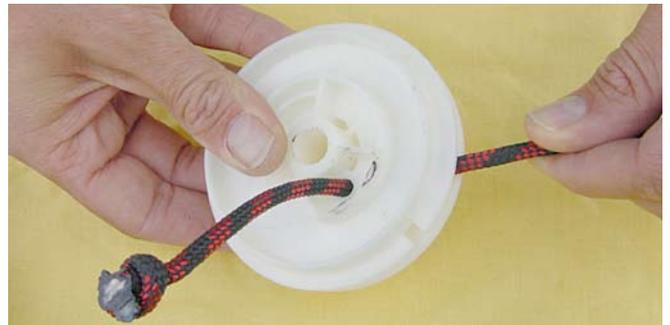
Um dem Starterseil Vorspannung zu geben, wird das aufgerollte Seil in die Nut gelegt und mit 3 Umdrehungen vorgespannt.
