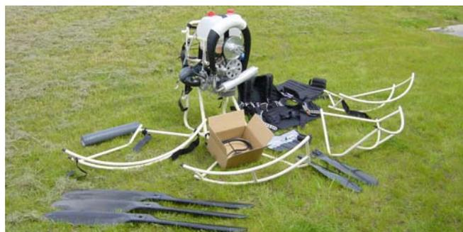
Alle 4 Käfigteile sollten zusammengesteckt und mittels der befestigten Klettverschlüsse gesichert werden.
