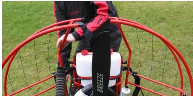
Eine Fixierung wird mit den Klettbandern verhindern unbeabsichtigtes lösen des Motors von Rahmen.
