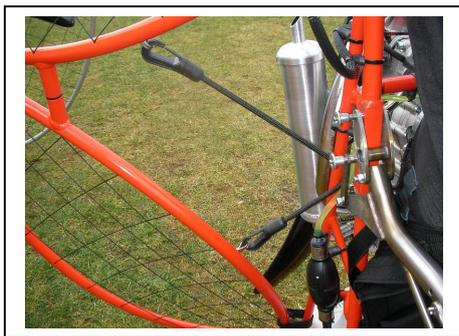
Das Starterseil wird in das rechte obere Käfigviertel gehängt.
