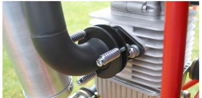
Nach 30 Stunden sollten die Brennring-Schrauben ersetzt werden. Nach 50 Stunden Überprüfung der Dichtringe und Dichtsitze.
