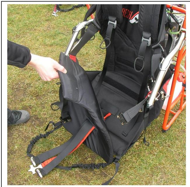
Der Schutzkäfig muss vor dem Flug mit dem Gummiband versehen sein. Dies schützt den Piloten vor dem drehenden Propeller.
