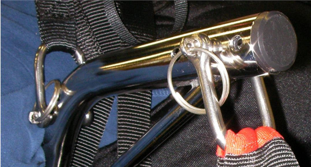
Die U-Schäkel werden mittels dieser Ringe gesichert. Wichtig ist, dass die Ringe in die Schäkel geführt sind.
