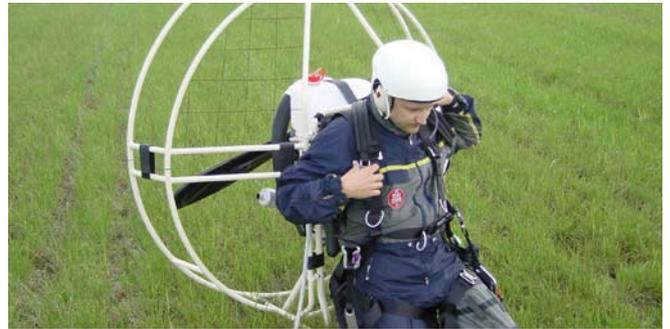
Danach wird die Pilotenaufhängung in die Abwurfvorrichtung des Motors eingehängt. Gewöhnlich wird das hinterste Loch verwendet. Die Abwurfvorrichtung sollte bei drohender Gefahr z.B. Wasserlandung, Feuer in großer Höhe oder Baumlandung aktiviert werden.
