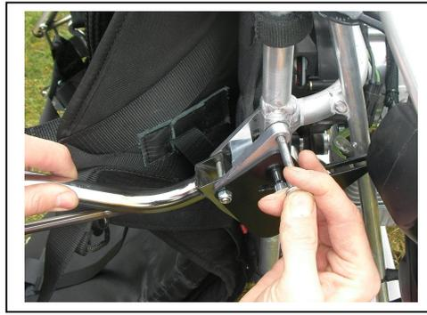
Die Trageriemen vom Gurtzeug werden wie im Bild gezeigt mit dem Verschluss verbunden
