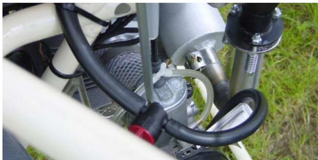
Airboxbefestigung beim Membranvergaser WB
