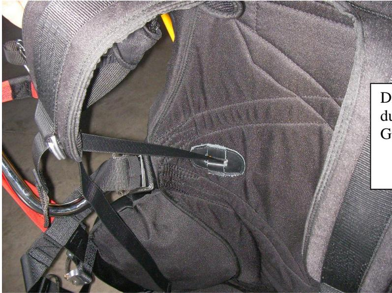
Die Tragegurte verlaufen nun durch das Rückenteils des Gurtzeuges
