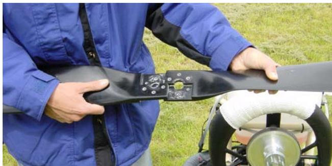
Der Propeller ist mit 6 Schrauben auf der Nabe befestigt. Angezogen wird der Propeller mit 12 Nm.
