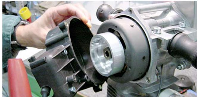
Ist die Zentralschraube herausgenommen, kann mittels eines Abziehers der Rotor abgezogen werden. Da der Rotor eine bestimmte Stellung zur Kurbelwelle haben muss, ist sein richtiger Sitz mit einer Scheibenfeder auf der Kurbelwelle vorbestimmt.
