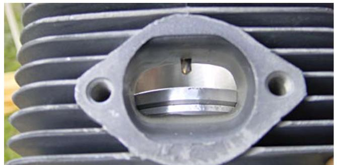
Wird der Zylinder wieder montiert, muss die Flüssigdichtung auf beiden Dichtflächen (Kopf und Zylinder), aufgetragen werden. Nach einer 5-minütigen Antrocknungszeit wird der Kopf nun mittels der 6 (M6 x 40) Schrauben wieder mit 14 NM angezogen.
