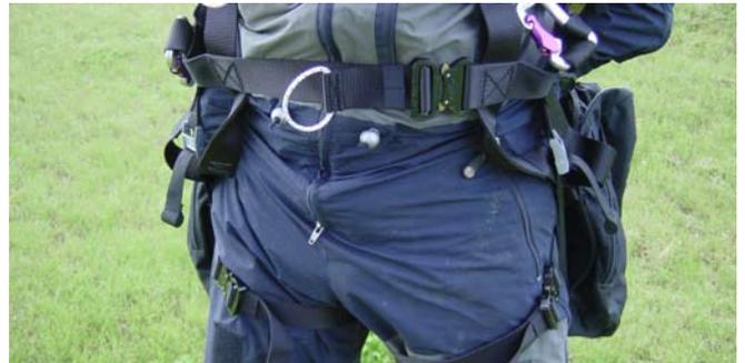
Dieses Gurtzeug ist speziell für den Motorbetrieb konstruiert. Beim Betrieb ist darauf zu achten, dass keine losen Teile während des Betriebs in den Propeller gelangen können. Die Pilotenaufhängung kann permanent in den Karabinern bleiben.
