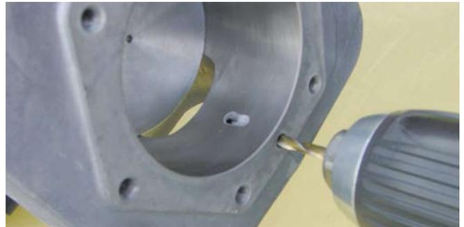
Gebohrt wird senkrecht von der Kopfdichtfläche hin zum Auslasskanal. Und diagonal zur Lauffläche in Richtung senkrechtem Bohrloch.
