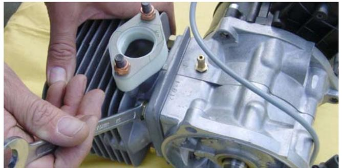
Der Zylinder kann nun vom Kolben gezogen werden.
