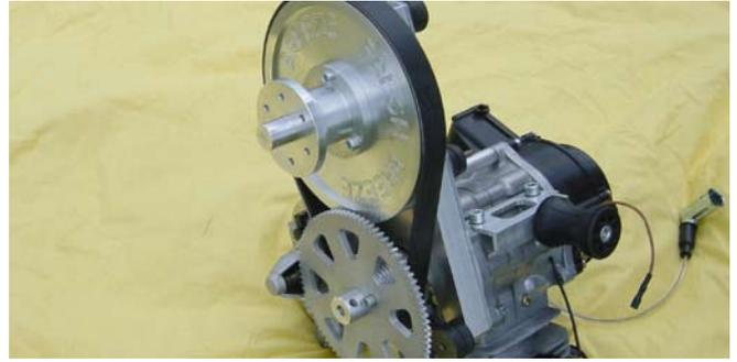
Im Zuge der Wartungsarbeiten sollte die Riemenspannung vor jedem Flug überprüft werden. Dabei sollte der Riemen nicht über 45° verdreht werden können. Besonders nach dem ersten Flug sollte besonders auf die Riemenspannung geachtet werden.
