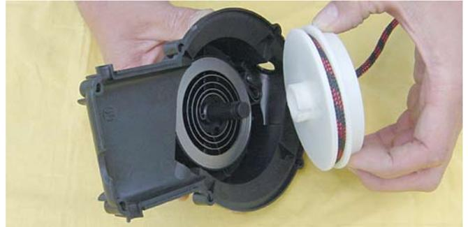
Weißer Rolle aus dem Deckel herausnehmen. Das Starterseil kann nun aus der Rolle gezogen werden.
