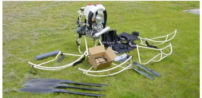
Alle 4 Käfigteile sollten zusammengesteckt werden und mittels der befestigten Klettverschlüsse gesichert werden.
