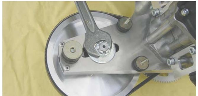
2. Mit der Spannschraube 8mm (z.B. 13mm gekröpfter Ringschlüssel) wird die Propellerwelle angehoben, so dass sich der Riemen lockert. Rechts drehen, Riemen wird strammer. Links drehen, Riemen wird locker.
