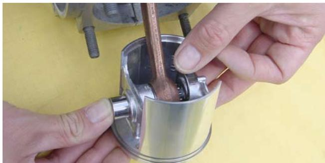
Diese Bild zeigt den Einbau der Sicherungsringe für den Kolbenbolzen.
