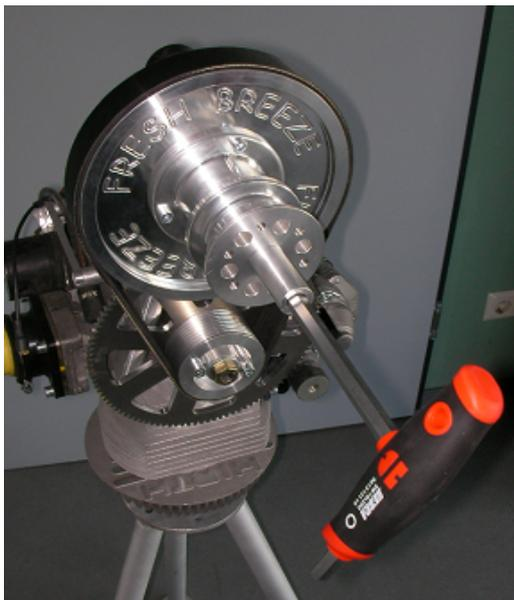
Die Riemen­spannung wird durch Verdrehen der
