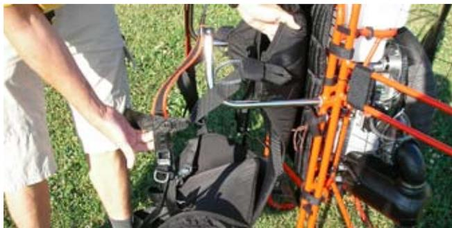
Die hintere Pilotenaufhängung wird mit dem Quickrelease in die Ringösen eingehängt.
