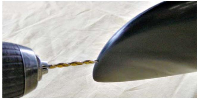
**ACHTUNG: EIN UNWUCHTIGER PROPELLER SETZT DEN MOTOR UNNÖ-TIGEN VIBRATIONEN AUS, SO DASS IN KURZER ZEIT VIELE BAUTEILE ZERSTÖRT WERDEN KÖNNEN.**
