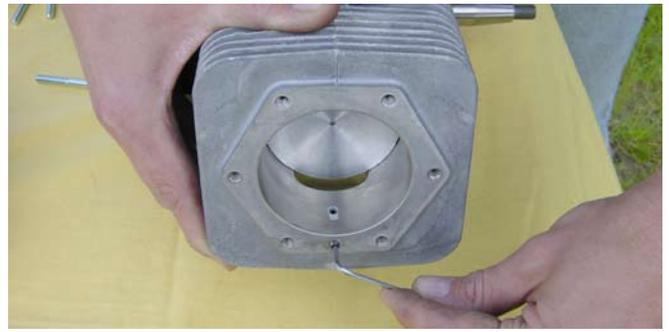
In der Lauffläche ist eine birnenförmige Vertiefung zu sehen. Diese sollte mit einem geeigneten Werkzeug freigekratzt werden. Nun sollte mit einem 4mm Bohrer der eigentliche Kanal vorsichtig freigebohrt werden.
