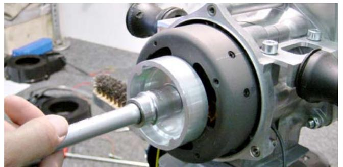
Um den Zündzeitpunkt einzustellen, müssen die beiden Halteschrauben des Stators gelöst werden. Der Stator wird maximal nach links bis zum Anschlag gedreht. Nun um ca 1mm wieder nach rechts. Halteschrauben wieder anziehen. Der Zündzeitpunkt hat nun seine korrekte Einstellung. Danach sollte auf den richtigen Abstand der Kontaktflächen der Spulen zu den Rotormagneten geachtet werden. Mittels Fühlerlehre ist der Abstand (0,25mm) zu prüfen und ggf. einzustellen.
