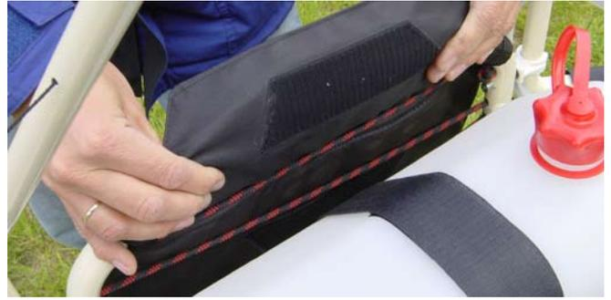
Ebenfalls wird das Rückenpolster seitlich mit Klettverschluss am Rahmen befestigt.
