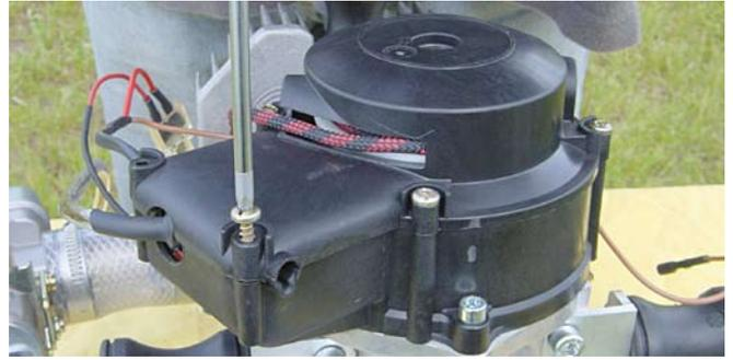
Nun sollte die weiße Rolle entgegen der Federkraft ent-spannt werden.
