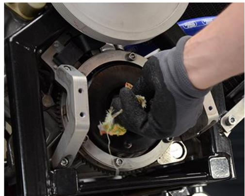
Die Kupplungsglocke mit Bremsenreiniger aussprühen, säubern und das Nadellager von Innen mit Wälzlagerfett fetten.
