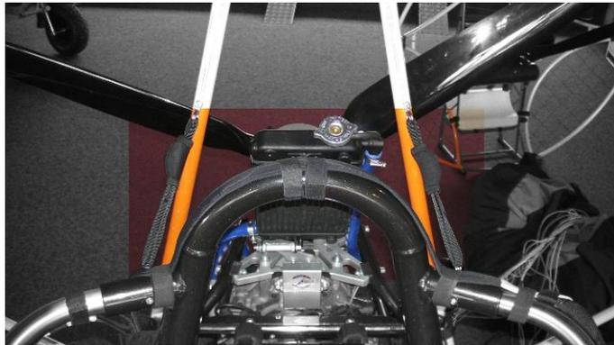
Ein zusätzliches Rohr dient zum Schutz für die Käfigleinen beim Start und der Landung. Nach der Montage des Käfig's sind diese in die Radnabe der hinteren Räder zu hängen.
