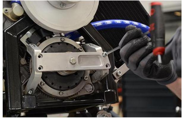
Haltestrebe abmontieren (M6x20 und 13er Sechskantschraube)
