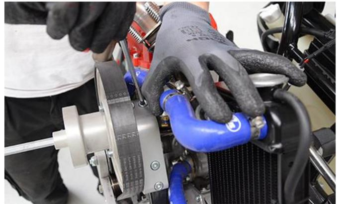
Mit einer Fühlerlehre wird die untere Riemenscheibe eingestellt.
