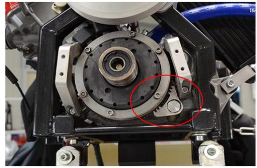
Kupplungsglocke mit einem 10er Steckschlüssel/Nuss ausschrauben.
