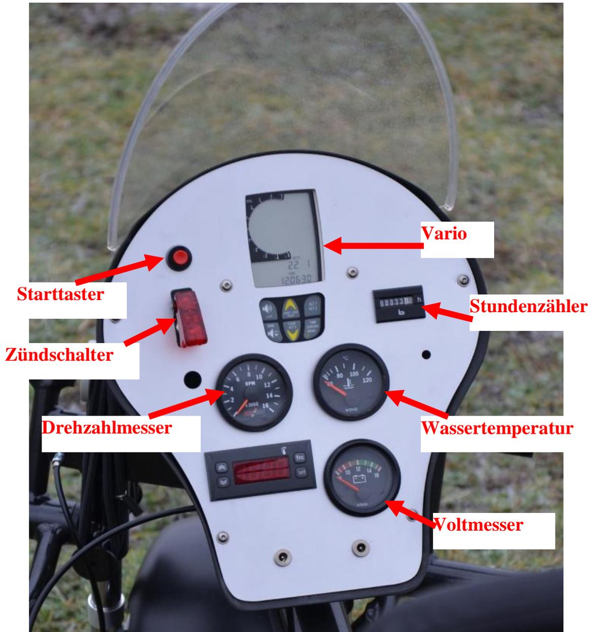
Wasser - und Öltemperaturanzeige liegt im Reiseflug zwischen 50-90 °C
