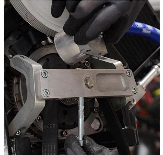
Schrauben der Halterstrebe lösen (Innensechskant 5 mm) und verdrehen.
