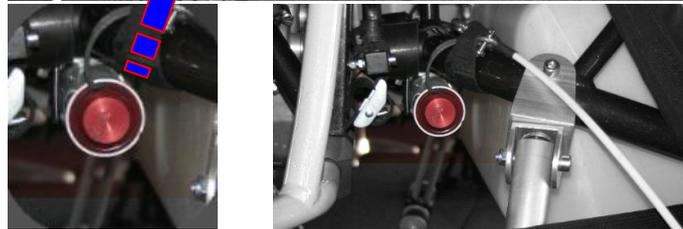
Der Auslösegriff ist mit einem Splint gegen unbeabsichtigtes Auslösen gesichert. Kurz vor dem Start muss der Splint gezogen werden.
