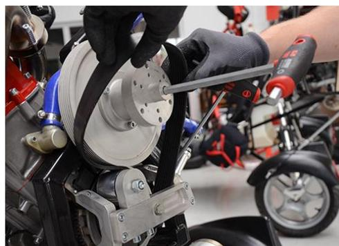
Schrauben des Anpressrollenhalteblocks mit dem Innensechskant (6mm) lösen und herausdrehen.
