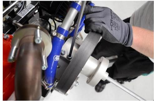
.... und mit einem Innensechskantschlüssel (10mm) von hinten in die Nabe der Excenter nach rechts gedreht und somit der Riemen gespannt. 8 PK 775 Optibelt. Anschließend die Klemmschrauben wieder anziehen.
