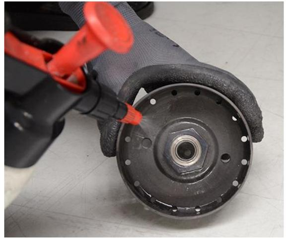
Die Schraube der Kupplungsglocke mit Lock-Tide versehen. Dann auf den Kurbelwellenzapfen stecken und festschrauben.
