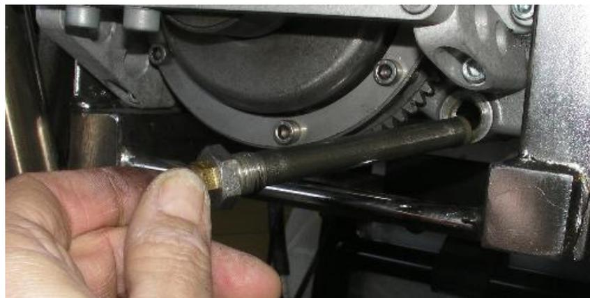
Bei jedem zweiten Ölwechsel muss dieses Sieb gereinigt werden. Gib beim montieren des Ölsiebs acht, dass der Stutzen im Ölraum getroffen wird.
