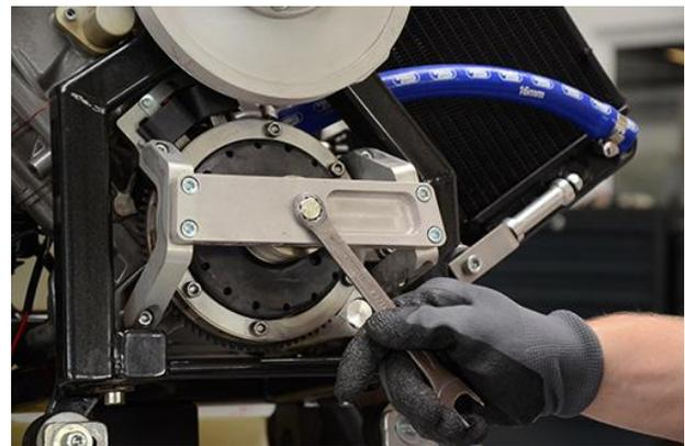
Aufgrund von Schmutz kann es sein, dass die Haltestrebe sich nicht einfach lösen lässt. Ein Gummihammer und ein Alukeil können beim sanften lösen helfen. Der Schmutz kann mit dem Rostlöser WD40 entfernt werden.
