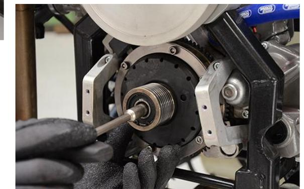
Die Haltestrebe festschrauben. Die 13er Sechskantschraube mit Lock-Tight versehen und festschrauben.
