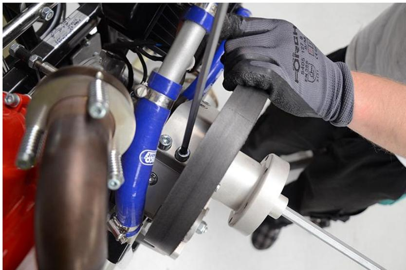
Mit einem Innensechskant (10 mm) die Lage der Nabe der Excenterachse einstellen.
