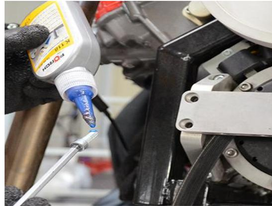
Die anderen Schrauben ebenfalls mit Lock-Tight versehen und festschrauben.
