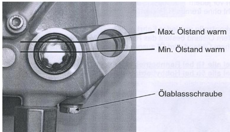
Die Ölablassschraube hat am oberen Ende einen eingelassenen Magneten. Dieser zieht Metallspäne an und muss bei jedem Ölwechsel gesäubert werden. Diese Schraube wird mit 26 Nm angezogen. ( M 14 x 1,5)
