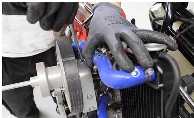
Beide Klemmschrauben für die Excenterachse mit einem Innensechskant (6mm) lösen.
