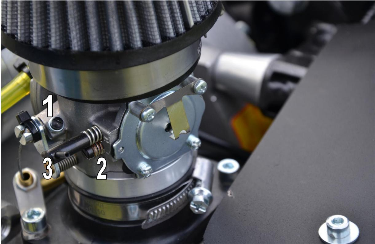
Der Boxer ist mit 2 Membranvergäsern WB 37 ausgerüstet. Die Vergäser brauchen nicht synchronisiert werden, da beide Zylinder auf einem nicht voneinander getrennten Kurbelgehäuse sitzen. Dennoch sollten die Einstellschrauben 1, 2 und 3 möglichst synchron stehen.
