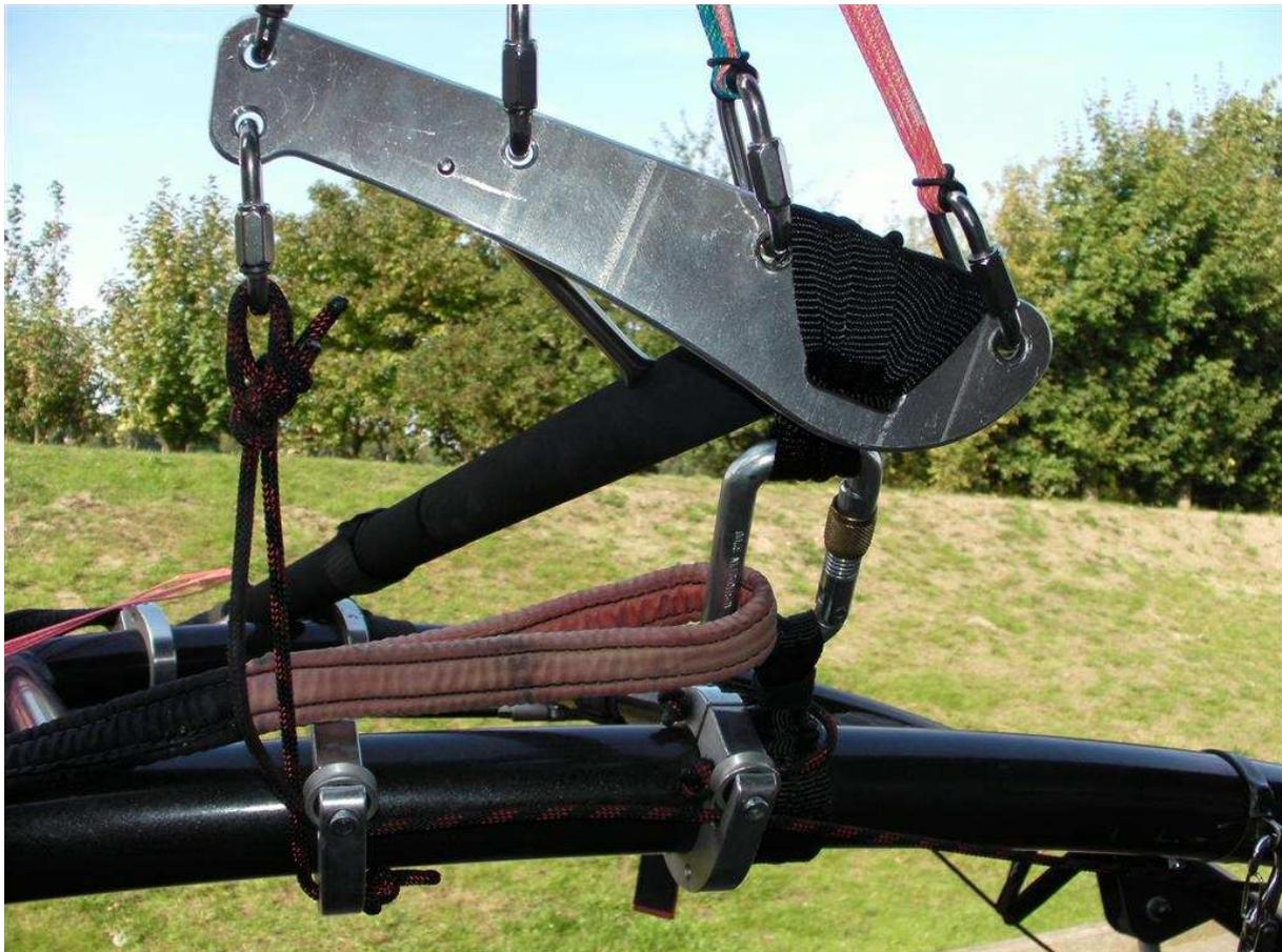
Das Pitch Control System (kurz: PCS) dient zur Stabilisierung und zur Reduktion von Nickbewegungen des XCitors im Fluge. Diese Stabilisierung wird dadurch erreicht, indem der XCitor seine Nickbewegung über zwei Aufhängepunkte pro Seite auf den Gleitschirm überträgt und sich so an dessen Fläche „abstützt“. Der Gleitschirm kann so wirkungsvoll Nickschwingungen der Zelle bedämpfen.
