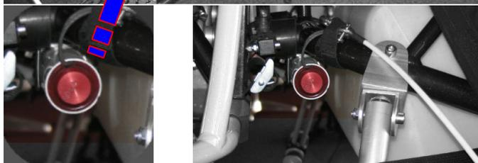
Der Auslösegriff ist mit einem Splint gegen unbeabsichtigtes Auslösen gesichert. Kurz vor dem Start muss der Splint gezogen werden.
