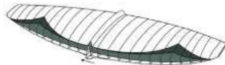
Abbildung 6: Als nächstes werden alle Rippen einer Seite wie bei einem Akkordeon so aufeinander gelegt, dass der Eintrittskantenbereich nicht geknickt wird.
