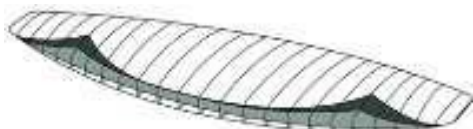
Abbildung 5: Den Schirm auf einer ebenen Fläche komplett auslegen.
